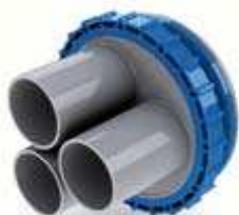
**Системная крышка с 3-мя штуцерами и 3-мя усадочными муфтами.** Подходит для 3-ех кабелей диаметром 21 – 56 мм. В качестве комплектующих поставляются разделительные колпаки АК или заглушки VS 60 в качестве глухих фланцев.
