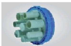
**Системная крышка с 8 штуцерами** и 4 усадочными муфтами. 4 штуцера при поставке закрыты, они могут быть при необходимости пробиты. Подходит для максимум 4 кабелей диаметром 7 – 23 мм и максимум 4 кабелей диаметром 12 – 33 мм.
