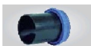
**Системная крышка с одним толстостенным штуцером** и соответствующей усадочной муфтой. Исполнение для 1 кабеля диаметром 60 – 158 мм или для присоединения защищающей кабель трубы с внешним диаметром максимум 160 мм.
