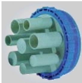
KD – система состоит из герметизирующей прокладки, которая выполнена как одинарный или двойной уплотнитель и монтируется рамками, имеющимися у уплотнительной прокладки к коробке и может быть забетонирована в опалубку. Крепление осуществляется штифтовыми гвоздями, отверстия для гвоздей – типовые.
