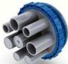
**Системная крышка с 8 штуцерами и 4 усадочными муфтами.** 4 штуцера при поставке закрыты, они могут быть при необходимости пробиты. Подходит для максимум 4 кабелей диаметром 7 – 23 мм и максимум 4 кабелей диаметром 12 – 33 мм.
